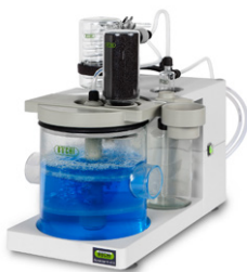
Scrubber K-415 Neutralización
