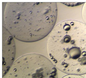
แคปซูลแอลจินเนตที่มีแกนกลาง เป็นน้ำมันแบบมัลติเฟลลอส
