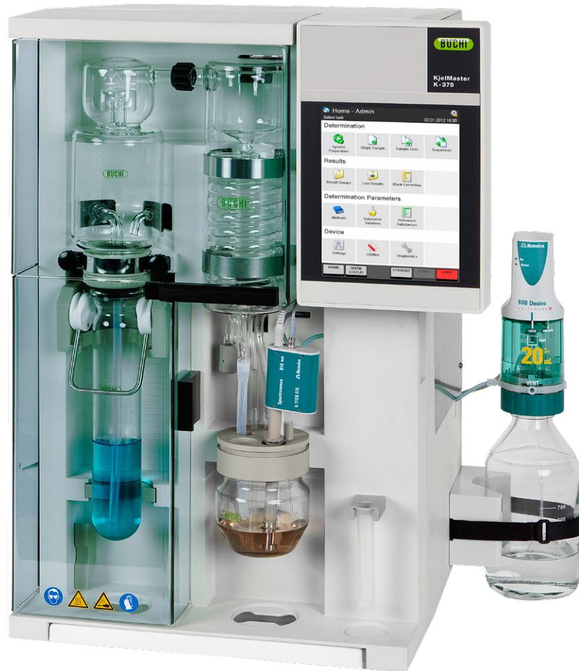
Système KjelMaster K-375 avec vase anti-projections en verre et sonde colorimétrique
