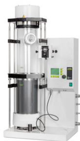
Nano Spray Dryer B-90 HP Secador por atomização para pequenas amostras e partículas
